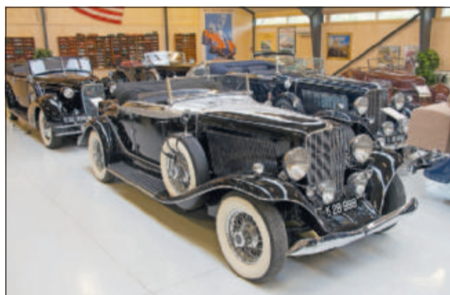
Denne 1934 Auburn Salon har en 6,4-liters V12-motor med 160 hk, friløb og 2-speed bagaksel. Vurdering: 2,3-3,6 mio. kr.
